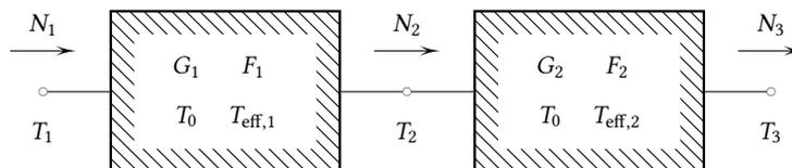
Abb. 3: Zur Herleitung der Kettenrauschzahl
