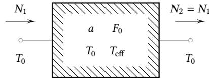
Abb. 2: Zur Herleitung der Rauschzahl eines Dämpfungsgliedes
